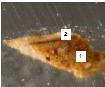
Fig.-5. Estratigrafía (2.09) Puertas de Pamplona (200x)
