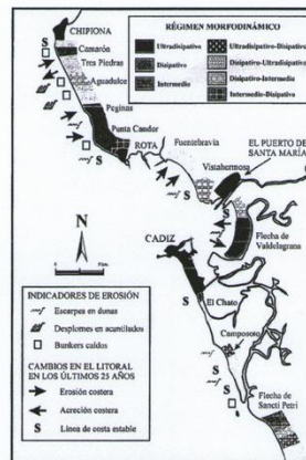
Mapa del régimen hidrodinámico de las playas de la Bahía de Cádiz. (Fuente: Cuantificación de procesos de erosión costera en el litoral suratlántico español. Primeros resultados. Universidad de Cádiz-Universidad de Huelva, 2002)
