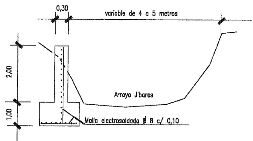
SECCION DEL MURO A CONSTRUIR
