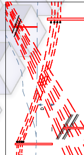
CRUZAMIENTOS CON LINEAS DE TELECOMUNICACION CON CONDUCTORES AISLADOS: LA LINEA DE BT DEBE CRUZAR POR ENCIMA O SER UNA DE ELAS DE CONDUCTORES AISLADOS DE 1000 V. EN EL VANO DE CRUCE O EXISTIR UN ANCHO DE CABLES DE ACERO PUESTO A TIERRA ENTRE AMBAS LINEAS DE TELECOMUNICACIONES DESNUDOS CON CRUZAMIENTO EN DISTINTOS APOYOS) D >= 0,5 m (PARA CRUZAMIENTO EN UN MISMO APOYO)
