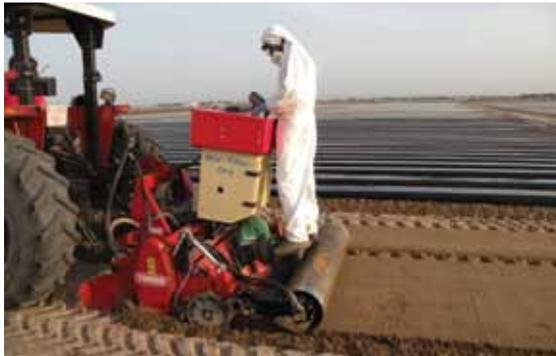
Figura 13. Maquinaria de aplicación con rodillo de compactación
