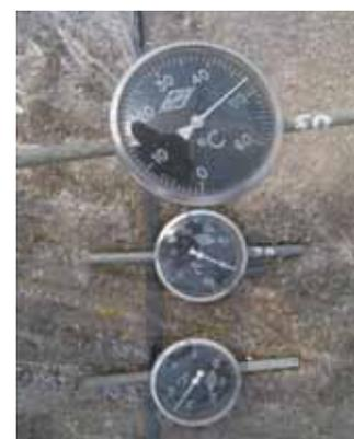
Figura 7. Termómetros para el registro de la temperatura del suelo
