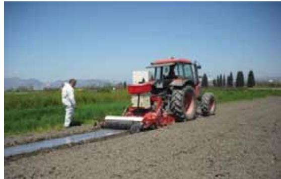
Figura 14. Maquinaria de aplicación con rodillo de compactación y dispositivo para colocar lámina de plástico
