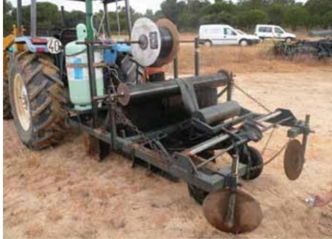
Figura 2. Máquina para inyección con reja
