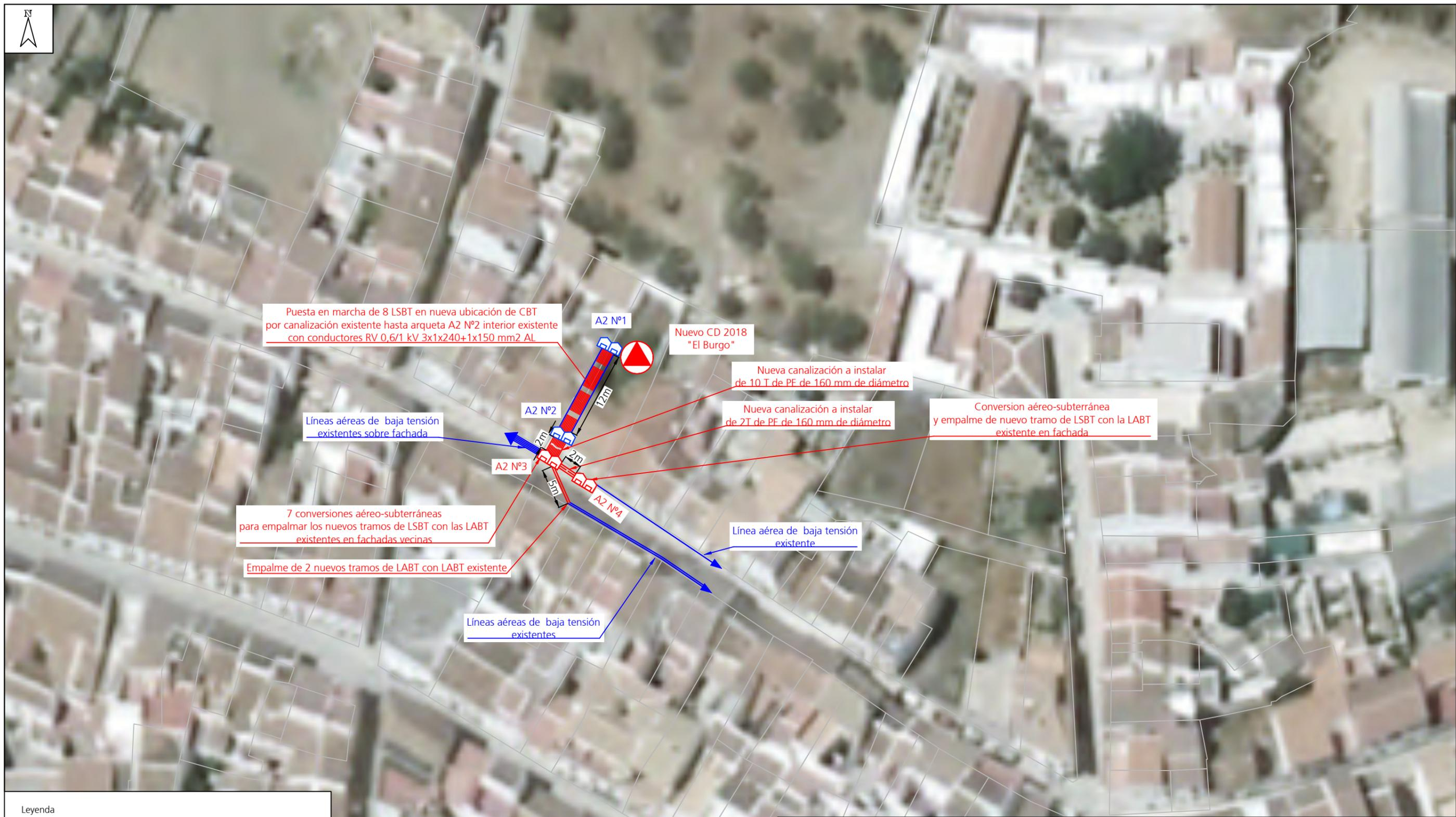
Puesta en marcha de 8 LSBT en nueva ubicación de CBT por canalización existente hasta arqueta A2 N°2 interior existente con conductores RV 0,6/1 kV 3x1x240+1x150 mm<sup>2</sup> AL
