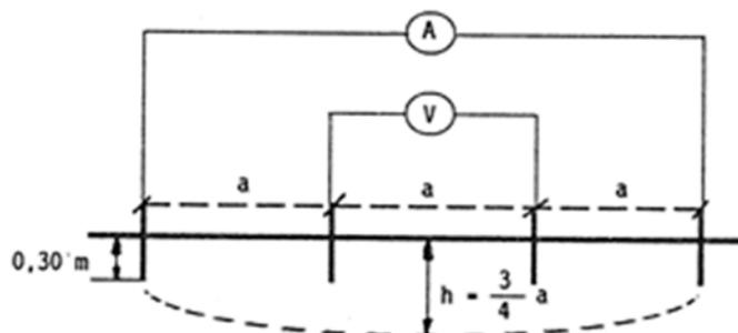
Dada la profundidad máxima a la que se instalará el electrodo de puesta a tierra del apoyo (h), calcularemos la interdistancia entre picas para realizar la medición mediante la siguiente expresión:
