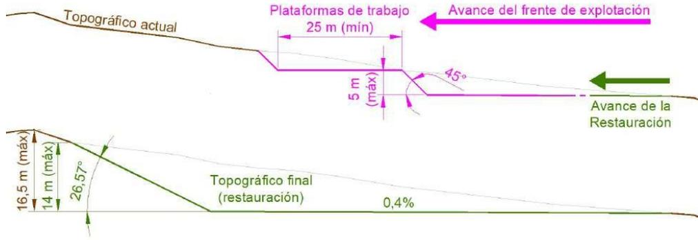
Ilustración 3: Modelo-tipo estructural en la extracción y en la restauración.
