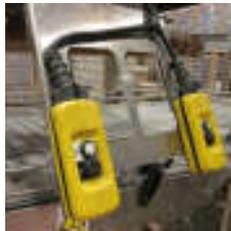
*Doble mando instalado en máquina de despaletizado*
