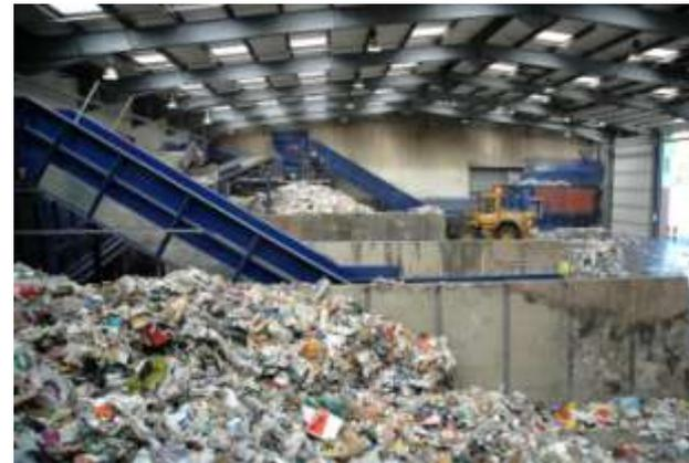
Todos los sistemas de separación y transporte están instalados en una nave industrial, por lo que uno de los principales riesgos que aparecen al poner en marcha la actividad es el ruido de los diferentes equipos y máquinas, y la reverberación en la estructura y paramentos del edificio. La evaluación del nivel de ruido es la herramienta utilizada por las empresas del sector para la definición de un plan de actuación sobre el ruido en cada puesto de trabajo.
