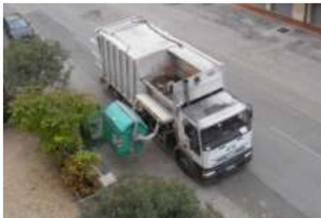
Al igual que en el caso de los camiones de carga trasera, muchos camiones de carga lateral de las empresas del sector tiene implantados sistemas de control de la carga de los vehículos de recogida. Se trata de una buena práctica relacionada con la seguridad que ya fue descrita en el apartado correspondiente a los vehículos de carga trasera.
