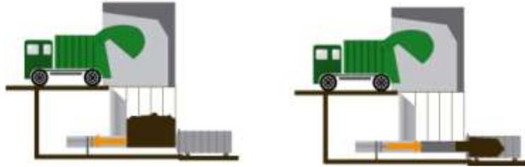
Como medida preventiva para evitar la caída del vehículo a la tolva, el borde de la zona de descarga tiene un bordillo señalizado de 30 cm de altura, de forma que actúa como tope para las ruedas traseras del vehículo. Asimismo, y para evitar las caídas de personas, existen barandillas que protegen las zonas que pueden quedar libres entre el vehículo y la estructura de la zona de descarga.
