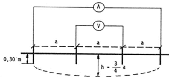
Dada la profundidad máxima a la que se instalará el electrodo de puesta a tierra del apoyo (h), calcularemos la distancia entre picas para realizar la medición mediante la siguiente expresión:
