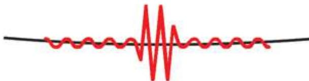
Espiral Salvapájaros de 2 puntas y 1 m de longitud. Válida para conductores de 7 a 21,80 mm de diámetro. Desde el LA-30 hasta LA-280.
