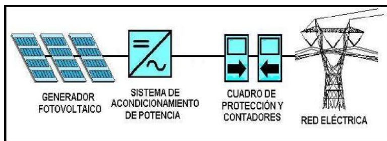
Figura 1. Esquema de un sistema fotovoltaico conectado a Red.
