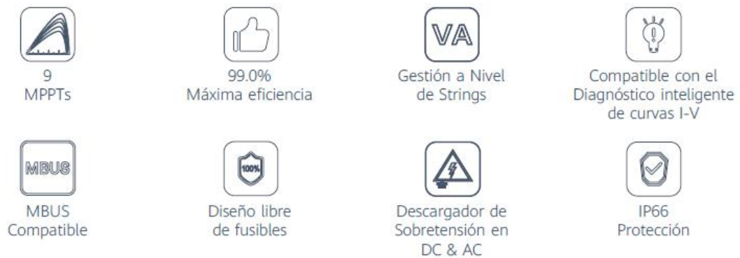
Figura 20. Inversor fotovoltaico 175kW. Resumen de características
