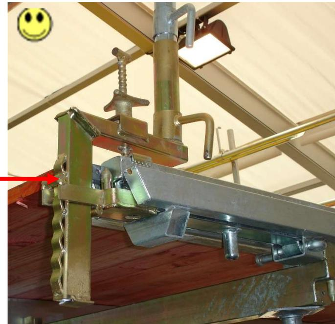
Barandilla de protección de borde sistema de encofrado STEN.
