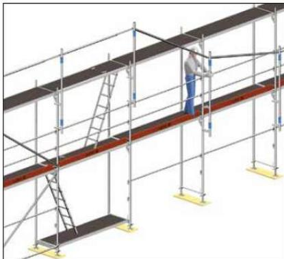
Fig. 26: Detalle que muestra el uso de barandilla de montaje
