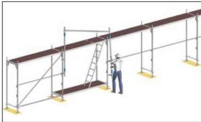
Fig. 25: Colocación de la barandilla de montaje en el módulo de acceso
