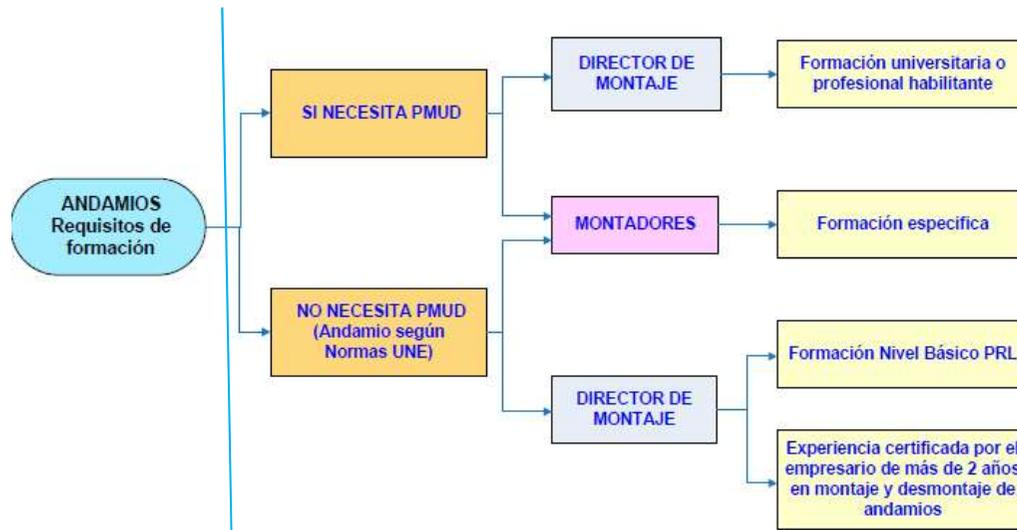
Figura 29. Requisitos de formación para la dirección del montaje y la manipulación de andamios
