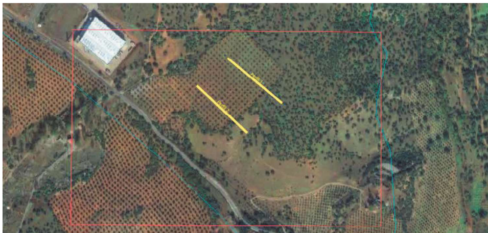
Figura 10. Distribución de perfiles para la campaña de geofísica eléctrica .
