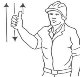
4 Levantar el aguilón o pluma lentamente
