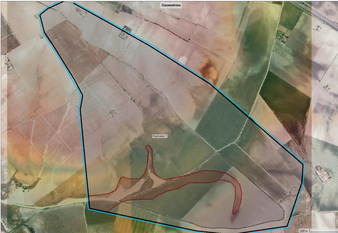
Mallado general del modelo zonas de mayor detalle.
