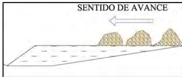
Figura nº 52. Sentido de avance desde el interior del relleno al borde.
