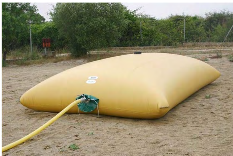
Figura nº 60. Depósito cerrado (Bladder Tank) de 10.000 litros.
