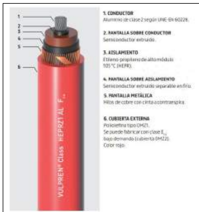
Figura 15. Partes del conductor VULPREN Class HEPRZ1 AL
