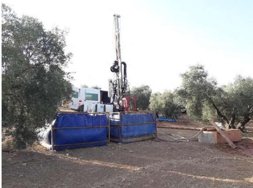
**Figura 31.** Balsas prefabricadas portátiles para la decantación del lodo (agua y piedra) de la perforación, usadas en otros proyectos de la empresa.
