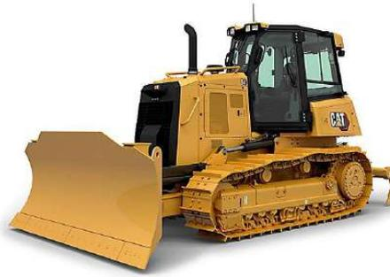
**Figura 29.** Retro mixta con cuchara de limpieza y bulldócer tipo CatD4. Equipos a usar en las labores de limpieza y creación de accesos.
