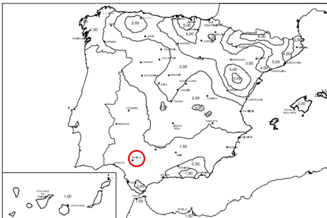
Figura 53. Densidad de impactos sobre el terreno. Fuente: CTE, R.D. 314/2006
