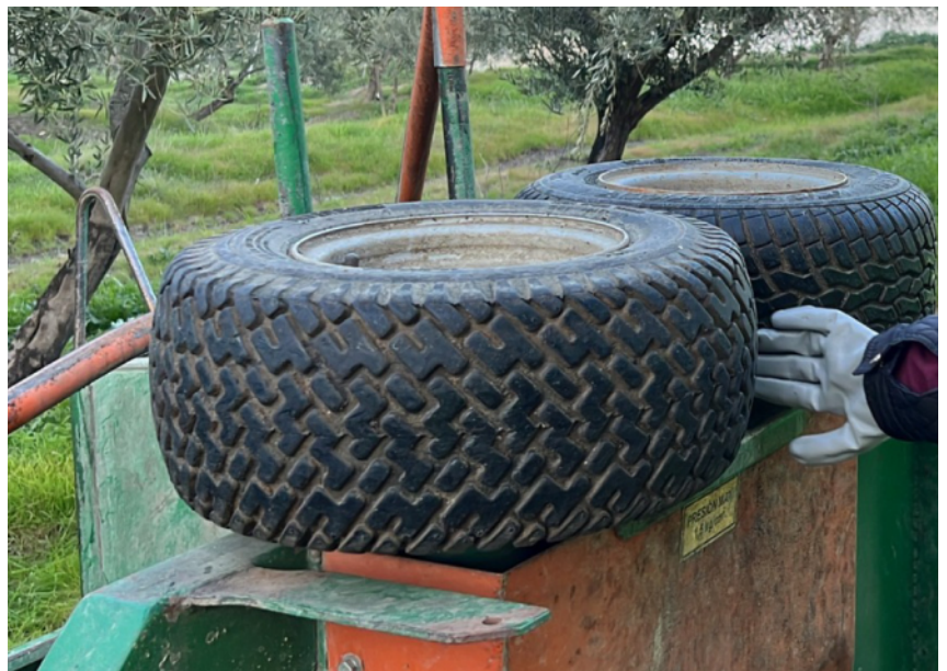
Zona con riesgo de atrapamiento entre las ruedas.
