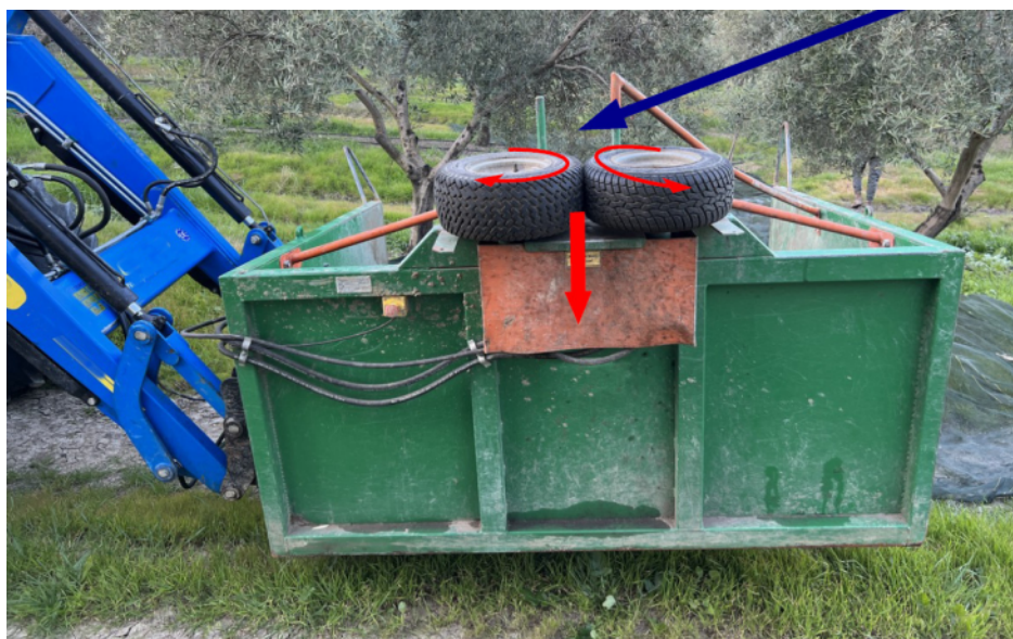
Detalle del sentido hacia donde giran normalmente el sistema motorizado de ruedas cuando pasa el fardo.
