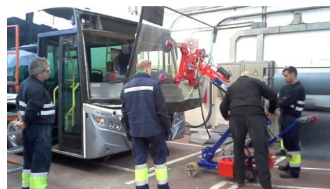
Ahora: Montaje de lunas con robot
