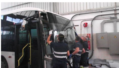
Antes: Montaje de lunas manual
