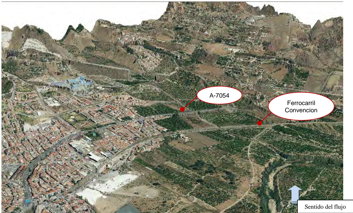
14 Vista de las dos delimitaciones artificiales de la llanura de inundación al Norte del río Guadalhorce: terraplén del ferrocarril convencional y el núcleo urbano de Cártama Estación
