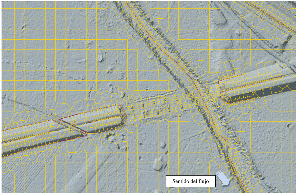
6 Línea de ruptura para definir el puente de la A-357 (Obra de Drenaje Transversal, terraplenes y pilas) y el cauce del río Guadalhorce
