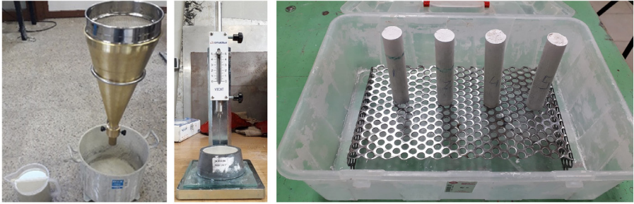
Figura 02. Cono de Marsh con tamiz incorporado, aguja de Vicat y ensayo de capilaridad.
