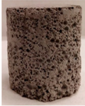
Figura 02. Geopolímero poroso basado en ceniza volante usando SDS como agente espumante.
