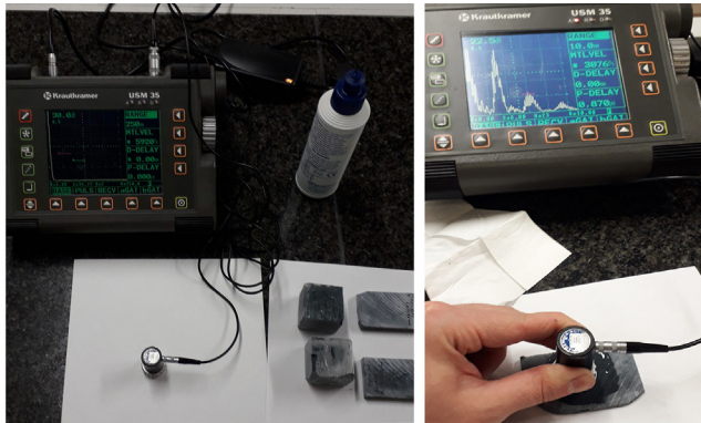
Figura 03. Ensayo de ultrasonidos directo.
