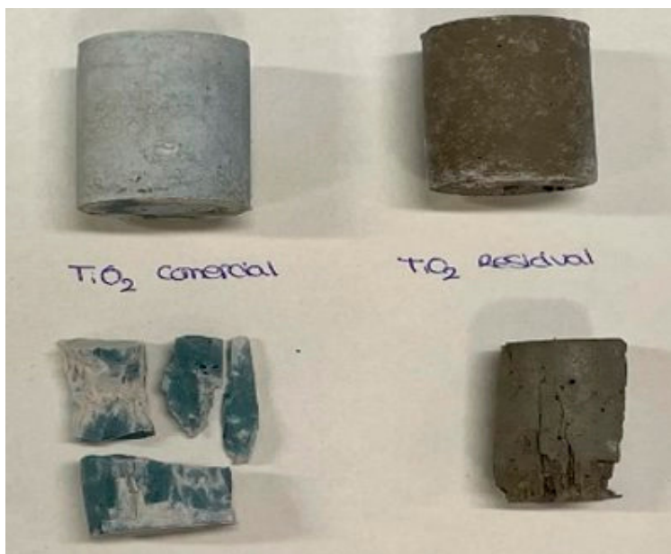
Figura 04. Geopolímero de \text{TiO}_2 comercial (izquierda) y residuo de \text{TiO}_2 (derecha).
