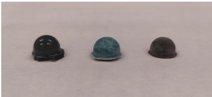
Figura 03. Pellets de geopolímeros de ceniza volante (izquierda), geopolímero de escoria de alto horno y \text{TiO}_2 comercial (centro) y geopolímero de escoria de alto horno y residuo de \text{TiO}_2 (derecha).
