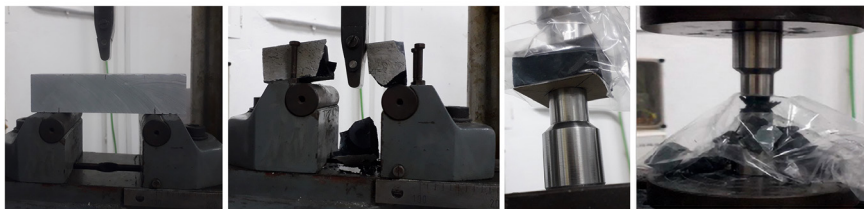
Figura 05. Ejecución y ensayo de flexión (izqda.) y Double Punch Test (dcha).
