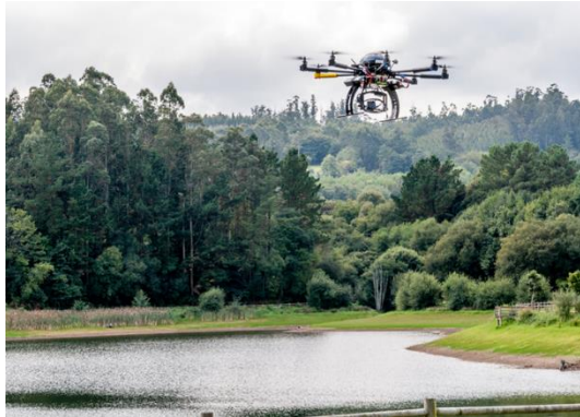
Monitorización de la calidad de las aguas mediante uso de drones. Fuente: 3edata
