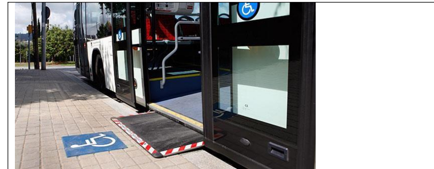
Rampa de acceso en autobús adaptado de EMTUSA
