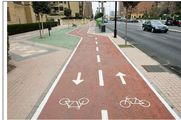
Señalización horizontal de acera bici bidireccional
