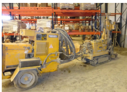
Perforadora que se acopla al compresor mediante manguera
