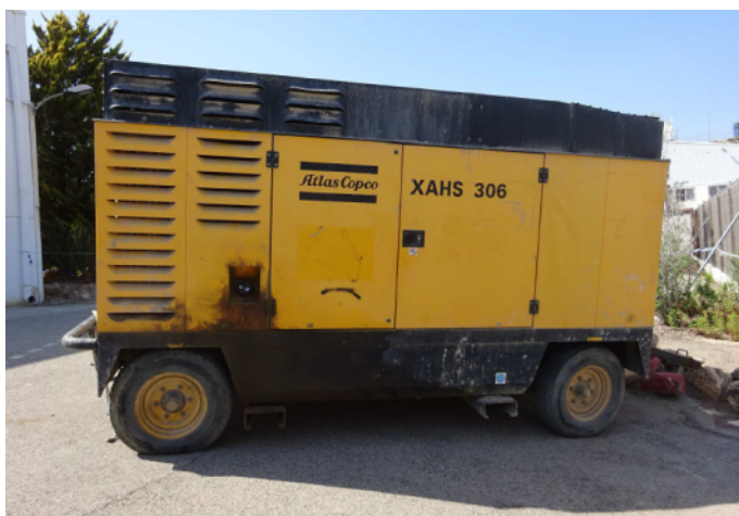
Compresor de aire móvil de gran tamaño y peso de 5.600 kg
