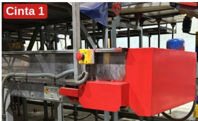
Detalle de las protecciones instaladas después del accidente.
